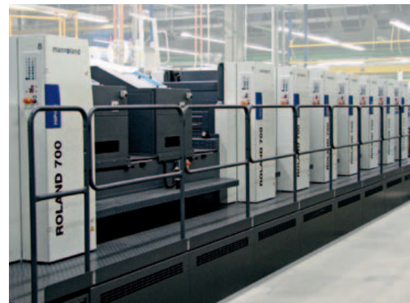
4 + 2 + 2: Perfekte Effekte für mehr Erfolg – man-roland R700 HiPrint, 6 Farben + Doppellackwerk, jüngstes „Kind“ im Drescher-Werk Rutesheim
